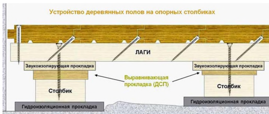
Рис. 28 Устройство деревянных полов на опорных столбах
