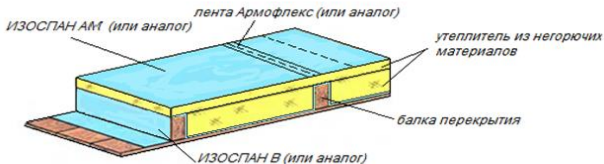
Рисунок 25 - Утепление деревянного перекрытия
