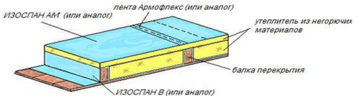
Рис. 24 Утепление деревянного перекрытия
