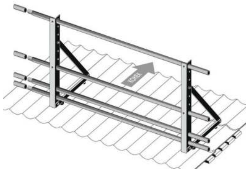
Рис. 15 Комбинированная система снегозадержания с ограждением заводского исполнения
