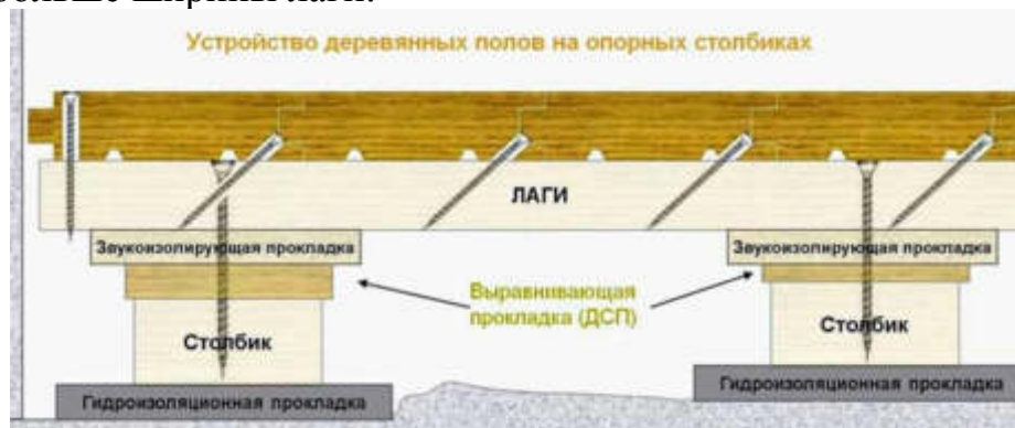
Рис. 29 Устройство деревянных полов на опорных столбах
