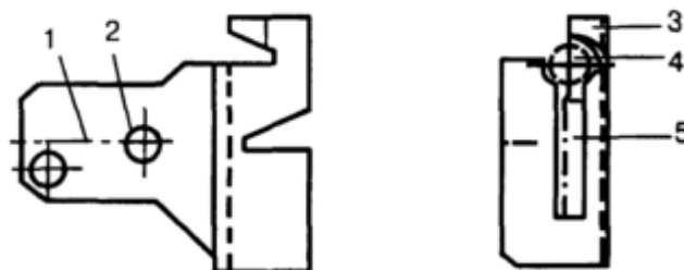
Рис. 4 Держатель шин заземления: 1 - место пристрелки; 2 - отверстие для крепления шурупами; 3 - отгибаемый элемент; 4 - место установки круглого проводника; 5 - место установки плоского проводника
